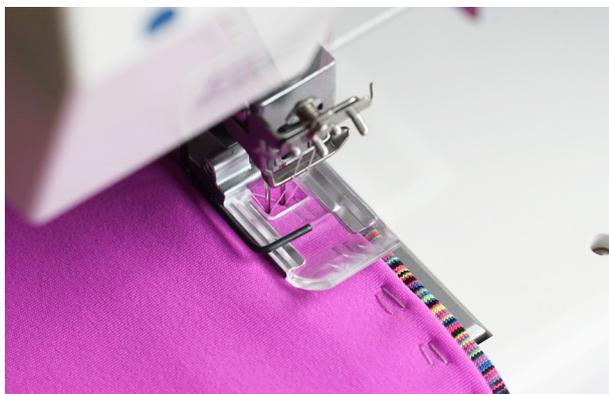
9. Setzen Sie den transparenten Nähfuß in Ihre easycover, um besser zu sehen, wo Sie nähen, und nähen Sie von rechts mit dem Programm Saumnaht mit 3 mm Breite.
