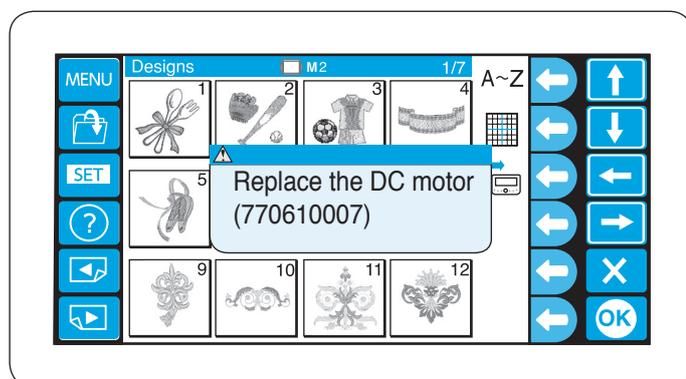
Wenn die Gesamtlaufzeit des Gleichstrommotors 1000 Stunden erreicht hat, wird eine Meldung angezeigt berät Sie den Gleichstrommotor zu ersetzen.
