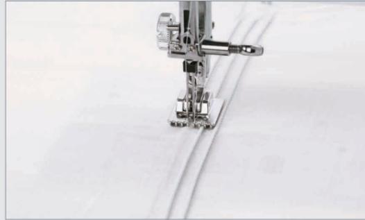
Biesen sind ein schönes Detail in der modernen Bekleidung. Es ist besonders wichtig, dass die Biesen in parallelen Reihen und mit gleichmäßigen Abstand genäht werden. Dieser Fuß garantiert ein optimales Ergebnis für schmale Biesen.
