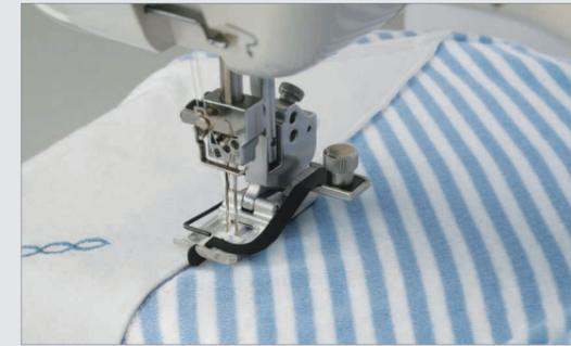
Nähen Sie mit einer Zwei- oder Dreinadel-Covernaht ganz exakt über einer Nahtlinie. Diese Technik ist hervorragend für Sportbekleidung geeignet und verleiht Nähten besondere Stabilität. Nutzen Sie diesen Stich auch, um Nahtzugaben flach festzustepfen oder als dekoratives Finish.
