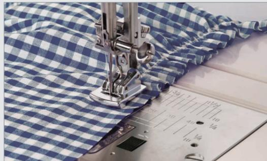
Dieser Fuß hilft Ihnen dabei, leichte Stoffe zu kräuseln. Die Unterseite des Fußes ist hinter der Nadel erhöht und vor der Nadel etwas dicker. So wird der Stoff gekräuselt und Sie können ihn gleichzeitig an einen anderen Stoff annähen. Für stärkere Falten verwenden Sie den Faltenleger.
