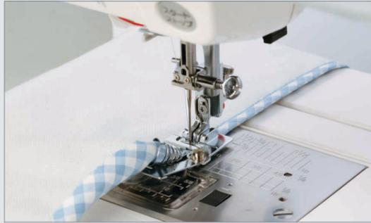
Nutzen Sie Schrägbänder als hübschen Kantenabschluss. Vorder- und Rückseite einer Näharbeit sind damit sauber eingefasst. Oder Sie nähen ganz einfach Knopfschlaufen, Bänder und Träger. Die Führung am Schrägbandfuß faltet Schrägbänder perfekt um Ihren Stoff.
