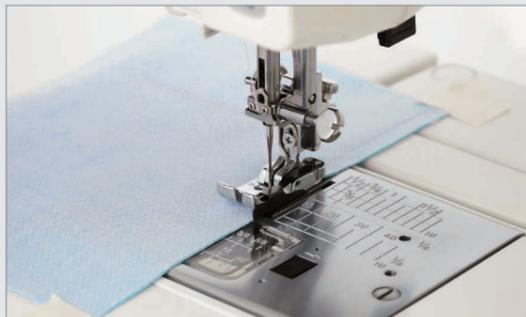
Gemessen von der mittleren Nadelposition bis zur Kantenführung können Sie mit diesem Fuß in kürzester Zeit eine perfekte ¼ Inch-Naht nähen. Die Führung hält dabei Ihren Stoff immer in optimalem Abstand.
