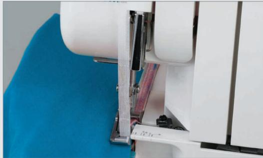
Dieses Zubehör in Verbindung mit dem passenden Band verhindert, dass sich Stoffe beim Nähen ausdehnen. Das Band wird an der Stoffkante mitgefasst.
