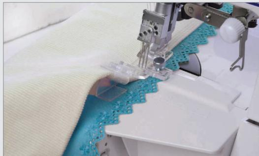
Diese Führung faltet und näht einen Saum von 6 mm (1/4"). Im selben Arbeitsschritt wird Spitze oder Zierband mit einem Coverstich an die Stoffunterseite genäht. Die Spitzenführung kann nur mit dem Decksaumfuß (M) 200-801-304 verwendet werden.
