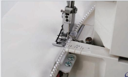
Perlen setzen einen schönen Akzent auf Schals, Säumen, Revers etc. Mit diesem Fuß können Sie Perlenschnüre (4 mm oder schmaler) mit einer Flatlock-Naht perfekt platzieren. Nutzen Sie den Fuß zusammen mit der Perlenstichplatte. Der schmale Stichbildungsfinger sorgt für einen sauberen Saum unter den Perlen.
