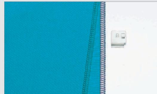
Biesen, die mit Kordeln verarbeitet wurden, liegen nie flach. Testen Sie diese Führung mit einfachem Stoff und farbigem Garn oder Kordel, Ton-in Ton oder als Kontrast: der Effekt ist spektakulär. Die Kordelführung kann nur mit dem Biesenfuß (K) 200-802-202 verwendet werden.
