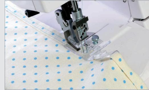
Diese Führung führt das Schrägband sauber um die Stoffkante. Nutzen Sie den Cover- oder Kettenstich, um das Band anzunähen. Die Schrägbandführung kann nur mit dem Decksaumfuß (M) 200-801-304 verwendet werden.
