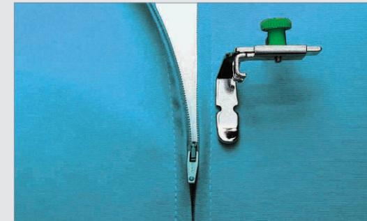
Bringen Sie den Fuß an und verstellen Sie die Nadel- oder Fußposition, damit Sie in der optimalen Position neben dem Reißverschluss nähen. Sie können den Fuß auch verwenden, um nahe an breiten Paspeln, z.B. in Heim- und Deko-Textilien, zu nähen.
