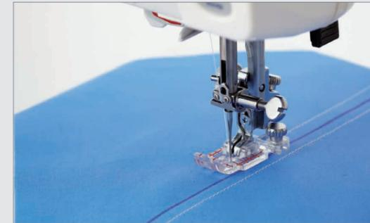
Zusammen mit der Geradstich-Stichplatte nähen Sie mit diesem Fuß eine optimale 1/4 Inch-Naht mit Geradstich. Dafür sorgt das kleine Nadeleinstichloch im Fuß und in der Stichplatte. Die Gefahr, dass feine Stoffe mit in das Stichloch gezogen werden, ist minimiert.
