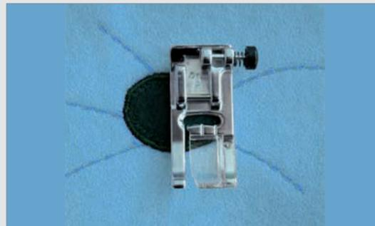
Dieser Fuß befindet sich an jeder Maschine. Er wird hauptsächlich für Geradstiche mit einer Länge von mehr als 1 mm und Zickzack-Stiche genutzt.
