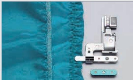
Der Gummibandkräusler macht die Arbeit fast von allein: Er dehnt das Gummi, während es mit der Overlock- oder Covernaht auf den Stoff genäht wird. Dieses Zubehör ist einfach handhaben und arbeitet sehr exakt. Es kann nur mit dem Mehrzweckfuß 200-805-009 verwendet werden.
