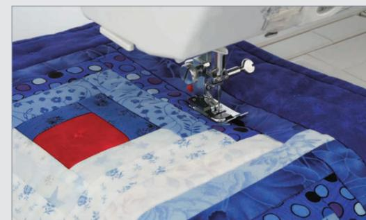
Nähen Sie „im Nahtschatten“: Die Führung hilft Ihnen dabei, während des Nähens im Nahtschatten zu bleiben. Dieser Fuß ist perfekt geeignet zum Absteppen von Quilts. Bei Bekleidung wird er z.B. gerne für das Steppen im Nahtschatten am Bund eingesetzt.
