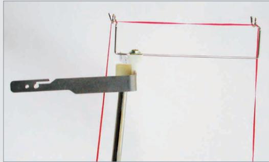
Wenn Sie industrielle Garnkonen nutzen möchten, stellen Sie diese Zusatzgarnführung hinter die Maschine und nutzen Sie sie für eine gleichmäßige Garnzufuhr.
