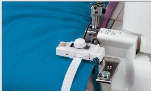
Dieses Zubehör dehnt das Gummiband vor dem Annähen mit der Overlock. Eine einfache Methode, um Gummiband von 3,5 mm bis 8 mm Breite anzunähen.
