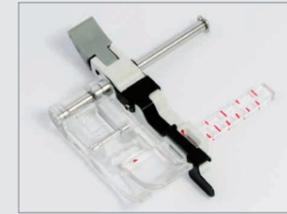
Mit der Führung dieses Fußes können Sie Kanten und Säume exakt parallel absteppen. Justieren Sie die Führung mit einem Schraubendreher. Der Fuß ist perfekt um Falten, Säume oder feine Kanten auf Spitze oder Band zu nähen und um dekorative Absteppungen zu erzeugen.
