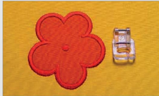
Dieser Nähfuß ist kürzer als die meisten anderen Nähfüße, um beim Applizieren einfacher um Kurven und Ecken zu nähen. Das durchsichtige Material erlaubt eine bessere Sicht auf das Nähgut.
