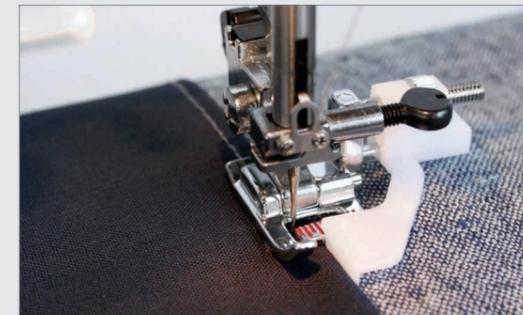
Mit der Führung dieses Fußes können Sie Kanten und Säume exakt parallel absteppen. Justieren Sie die Führung mit einem Schraubendreher. Der Fuß ist perfekt um Falten, Säume oder feine Kanten auf Spitze oder Band zu nähen und um dekorative Absteppungen zu erzeugen.
