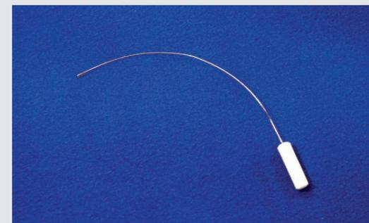
Dieses Werkzeug ist für das schnelle und einfache Einfädeln des unteren Greifers Ihrer Overlockmaschine 264 sehr hilfreich.
