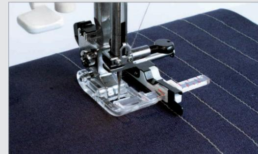
Kanten nähen ist mit diesem Fuß ganz leicht. Sie können die Führung an der Seite des Fußes bis zu einem Kantenabstand von 25 mm verschieben, um gleichmäßige Säume zu nähen. Die Führung kann stufenlos verstellt werden, indem Sie den Hebel an der Rückseite anheben. Die Markierungen erleichtern Ihnen das exakte Arbeiten.
