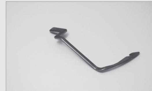
Dieser Decksaum-Haken wurde speziell für den oberen Decksaum entwickelt.
