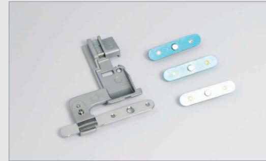
Mit dem Gummibandkräusler können Sie ganz einfach Gummiband aufnähen – er macht die Arbeit fast von allein. Außerdem können Sie mit diesem Set eigenes Soutache-Band erstellen. Nähen Sie Gummiband von 7,5 mm, 10 mm und 13 mm direkt auf den Stoff. Durch Verstellen der Schraube verändern Sie den Zug auf das Gummiband.
