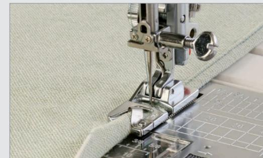
Dieser Fuß wird verwendet, um feine Rollsäume in leichte oder mittelschwere Stoffe zu nähen. Nähen Sie die ersten Stiche, fixieren Sie den Stoff mit der Nadel-unten-Position und führen Sie ihn vorsichtig in den schmalen Trichter. Dann lassen Sie den Fuß seine Arbeit tun! Die Bestellnummer 200-326-023 enthält, das den Fuß für den 4 mm und 6 mm breiten Rollsaum.
