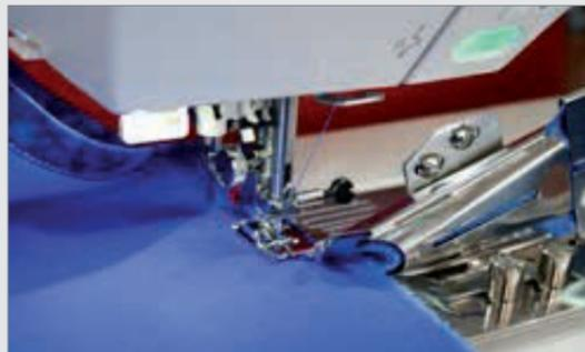
Das Quilteinfass-Set ist das perfekte Zubehör für das schnelle und unkomplizierte Einfassen Ihres Quiltes. Die spezielle Führung führt und faltet Stoffbreiten von 50 mm auf 15 mm fertige Einfassbreite.
