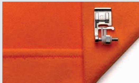
Unabhängig davon, wie schwer Ihr Stoff ist, stellt dieser Fuß sicher, dass die Nadel nur ein oder zwei Fäden des Saumes greift. Justieren Sie den Fuß für präzises Absteppen oder präzises Nähen von Kanten und Biesen. Auch den Mittelkantenfuß können Sie zum Nähen eines Blindsaums verwenden.
