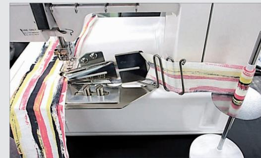
Perfekt geeignet, um Einfassband aufzunehmen. Der Bandhalter sollte auf der selben Höhe positioniert werden, wie der Bandeinfasser, den Sie verwenden. Durch den rotierenden Stab rollt das Band gleichmäßig ab und Sie erzielen besonders schöne Ergebnisse. Empfohlen zusammen mit dem Bandeinfasser-Set, Art.-Nr. 795-838-114 und 795-844-032.
