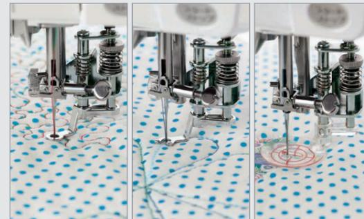
Dieses Set beinhaltet drei Füße und einen Fußhalter. Für stabilen Halt werden die Füße mit einer Schraube befestigt. Das Set besteht aus einem Klarsichtfuß für unebene Oberflächen, einem offenen Fuß für mehr Sicht und einem geschlossenen Fuß für den allgemeinen Gebrauch.
