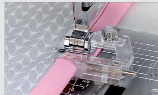
Mit diesem Fuß können Sie ganz einfach Stoffkanten mit Band einfassen. Der Fuß ist verstellbar und kann mit Bandbreiten von 5 bis 20 mm verwendet werden. Sie können ihn für einfach und doppelt gefaltetes Band verwenden.
