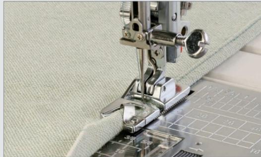
Dieser Fuß wird verwendet, um feine Rollsäume in leichte oder mittelschwere Stoffe zu nähen. Nähen Sie die ersten Stiche, fixieren Sie den Stoff mit der Nadel-unten-Position und führen Sie ihn vorsichtig in den schmalen Trichter. Dann lassen Sie den Fuß seine Arbeit tun!
