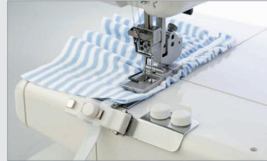
Gummibandaufnähen ist nie leichter gewesen. Der Gummibandkräusler arbeitet wie eine dritte Hand und dehnt das Gummiband während des Nähens. Verwendbar für Gummibandbreiten von 6 mm bis 8,5 mm und von 10 mm bis zum 12 mm.
