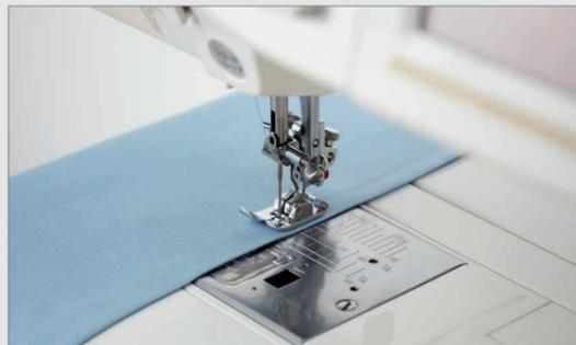
Der Geradstichfuß hat nur ein einzelnes, kleines Stichloch und eine flache Unterseite. So erzeugen Sie eine perfekte gerade Naht, ohne Stoffkräuseln oder übersprungene Stiche auch bei leichten Stoffen.
