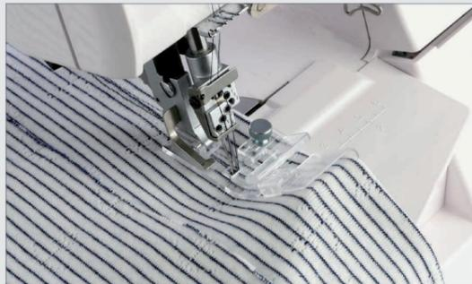
Gleichmäßige Säume, ohne zu messen, zu stecken und zu bügeln. Einfach den Stoff einlegen und die Führung faltet den Saum automatisch auf 2,5 cm (1") und näht ihn mit einem Coverstich fest. Die Saumführung (H-2) kann nur mit dem Decksaumfuß (M) 200-801-304 verwendet werden.
