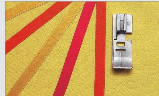
Ein sehr vielseitiger Fuß, der schnell und akkurat 1 cm breite Bänder (3/8") oder Streifen mit einem Coverstich auf den Stoff aufnäht. Nutzen Sie ihn mit der Kordelführung und dekorativem Garn, um Borten zu nähen. Oder lassen Sie bei Stretchstoffen ein Band in den Nähten mitlaufen, um sie zu stabilisieren.
