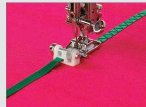
Es ist so einfach, Bänder und Paillettenbänder aufzunähen. Der Fuß ist mit Führungen ausgestattet, in die das Band oder Paillettenband eingelegt wird. Es läuft beim Nähen gleichmäßig mit. Sie können sich auch ein schönes und praktisches Gardinen- oder Zierband erstellen, indem sie einen breiten Leiterstich über ein schmales Band nähen.
