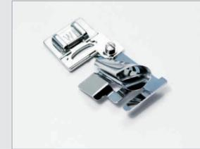
Der Schrägbandfuß wird benötigt, um mit vorgefaltetem oder selbstgeschnittenem Schrägband eine Kante einzufassen. Er ist mit einem Trichter ausgestattet, der das Band faltet und um den Stoff führt. Sie können Zickzackstiche, dekorative Stiche oder Nutstiche zum Annähen verwenden. Geeignet für Schrägband von 10 mm bis 14 mm.
