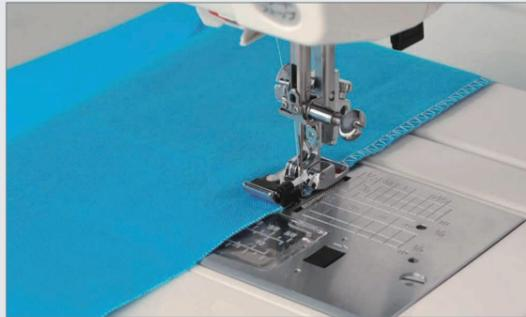
Versäubern Sie Schnittkanten in jedem Stoff schnell und effektiv mit einem Zickzack-Stich. Mit diesem Fuß reguliert sich die Fadenspannung so, dass der Stich flach liegt. Perfekte Ergebnisse erzielen Sie mit mittelschweren Stoffen.
