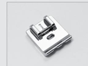
Der Paspelfuß ist ideal, wenn Sie kein fertiges Paspelband erhalten oder Sie einfach Ihre eigenen Paspeln erstellen möchten. Dieser Fuß ist mit zwei Führungen auf der Unterseite ausgestattet, die eine Paspelkordel halten und beim Nähen führen. Er kann ebenso beim Aufnähen von Paspeln verwendet werden. Die maximale Paspelbreite beträgt 5 mm.
