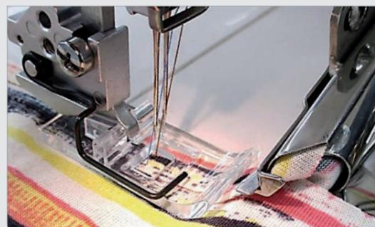
Verwenden Sie diesen Einfassbandfuß für die Verarbeitung von Einfassband an T-Shirts. Durch die transparente Sohle haben Sie beim Nähen eine sehr gute Sicht. Die Führung sorgt für eine leichte Handhabung. Dieser Fuß kann auch mit dem Bandeinfasser-Set 795-838-114 und 795-844-032 verwendet werden.
