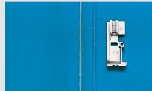
Paspeln setzen Akzente bei modischer Kleidung. Die Rille unter dem Fuß führt die Paspelkordel beim Nähen nah an der Nadel. Verwenden Sie diesen Fuß mit der Bandführung, um Schrägband um die Kordel zu legen, bevor die Paspel angenäht wird.
