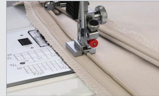
Hochwertige Bekleidung hat oft einen nahtverdeckten Reißverschluss. Das Geheimnis beim Einnähen dieses Reißverschlusses ist, die Nadel so nah wie möglich an die Reißverschlusszähnen zu bringen. Dieser Fuß entrollt den Reißverschluss unmittelbar vor der Nadel und ermöglicht so ein optimales Einnähen.
