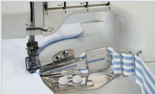
Falten Sie Schrägband und bringen Sie es mit dem Cover- oder Kettenstich an. Sie erzielen damit ein eindrucksvolles Finish etwa an Tischdecken, Handtüchern oder Jacken. Die Einfassung "Schmal" hat eine Breite von 8 mm bei 32 mm Breite des Schrägbandes. Die Einfassung "Breit" hat eine Breite von 12 mm bei 42 mm Breite des Schrägbandes.
