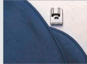
Der Paspelfuß ist ideal, wenn Sie Ihr eigenes Paspelband erstellen. Er ist mit zwei Führungen auf der Unterseite ausgestattet, die eine Paspelkordel halten und beim Nähen führen. Er kann ebenso beim Aufnähen von Paspeln verwendet werden. Die maximale Paspelbreite beträgt 5 mm.
