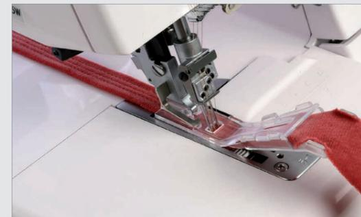
Sie können ganz einfach Gürtelschlaufen wie in der Bekleidungsindustrie herstellen, indem Sie die breite Zweinadel- oder Dreinadel-Saumnaht einsetzen. Der Fuß faltet das Band für Gürtelschlaufen automatisch. Oder Sie fertigen Knopfschlaufen oder schmale Bänder an und setzen dekorative Ideen um.
