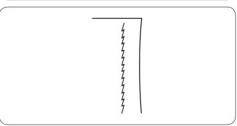
Dieser schmale Stretchstich verhindert, dass Wirkwaren und Schrägnähte sich kräuseln, und ermöglicht gleichzeitig, dass die Naht vollkommen geöffnet und flach gelegt werden kann
