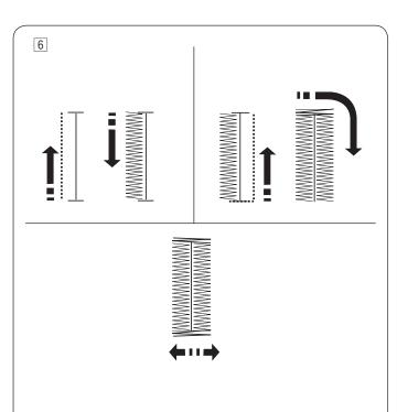
© Das Knopfloch wird automatisch in der gezeigten Reihenfolge genäht. Nach Fertigstellung des Knopfloches stoppt die Maschine automatisch mit der Nadel in der hochgestellten Position.
