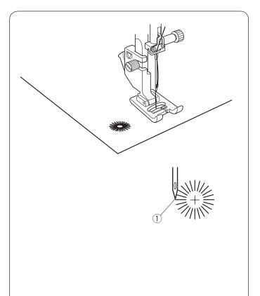
Die Öse wird für Gürtellöcher usw. verwendet.
