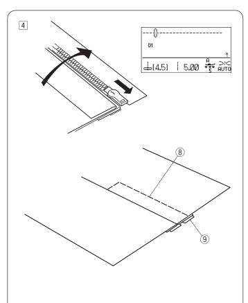
4 Schließen Sie den Reißverschluss und legen Sie den Stoff mit der rechten Seite nach oben flach über den Reißverschluss. Bringen Sie den Zick-Zack-Fuß A an.
