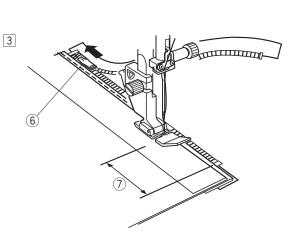
2 Befestigen Sie den Reißverschlussfuß. Stellen Sie die Stichbreite auf 7,5 - 8,5. Senken Sie den Nähfuß. Nähen Sie vom Ende der Reißverschluß-Öffnung aus und und führen Sie die Reißverschlusszähne an der Seite des Fußes entlang. Die Nadel sticht dabei durch die Kante der umgelegten unteren Nahtzugabe und durch das Reißverschlußband.
