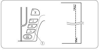
Benutzen Sie diesen Stich, um den Anfang und das Ende einer Naht durch Rückwärtsstiche zu vernähen. Wenn Sie das Ende der Naht erreicht haben, betätigen Sie die Rückwärtsnähtaste ① einmal. Die Maschine näht vier Rückwärtsstiche, vier Vorwärtsstiche und hält dann automatisch an.
