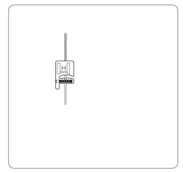
Führen Sie eine Garnschnur unter die am Fuß befindliche Feder und ziehen Sie sie unter den Fuß nach hinten (benutzen Sie den mittleren Schlitz der Feder).
