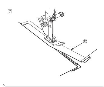
5 Befestigen Sie den Reißverschlussfuß E. Stellen Sie die Stichlänge auf den Standardwert, die Stichbreite auf 0,5 - 1,5 und die Fadenspannung auf "AUTO".
