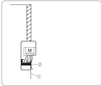
Dieser Stich wird zum Nähen von Stoffen wie synthetische Maschenware und Stretchstoffe empfohlen, da er größtmögliche Elastizität und Stärke bietet.
