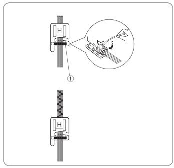
Führen Sie drei Garnschnüre unter die am Fuß befindliche Feder und ziehen Sie sie unter den Fuß nach hinten.
