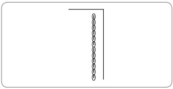
Dieser starke, haltbare Stich ist dann zu empfehlen, wenn Elastizität und Stabilität erforderlich sind. Benutzen Sie ihn, um Bereiche wie Schritt-und Ärmeleinsatznähte zu verstärken. Er kann auch als haltbarer und gleichzeitig dekorativer Stich, z.B. beim Nähen von Taschen, verwendet werden.
