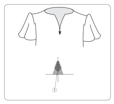
Der Dreieckriegel ist ein verstärkender Dreieckstich, der am unteren Ende eines Schlitzes, eines Hosenreißverschlusses oder den Seitentaschen von Hosen verwendet wird.
