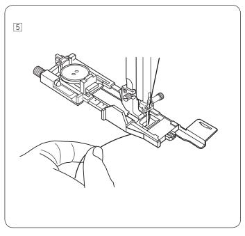
Beginnen Sie mit dem N\u00e4hen und ziehen Sie den Oberfaden gleichzeitig nach links. Lassen Sie den Faden nach einigen Stichen los und n\u00e4hen
