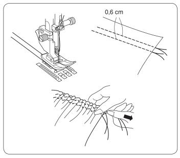
Lockern Sie die Fadenspannung auf "1" und erhöhen Sie die Stichlänge auf 5,0.
