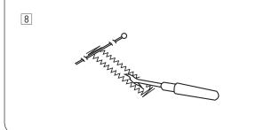
Bringen Sie an jedem Ende direkt vor dem Riegel eine Stecknadel an, damit die Stiche beim Aufschneiden des Knopfloches nicht versehentlich zerschnitten werden. Schneiden Sie die Öffnung mit einem Nahttrenner auf. Benutzen Sie einen Pfriem, um ein Augenknopfloch zu öffnen.
